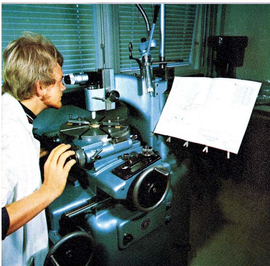
Horloger-calibriste réalisant à la machine à pointer un prototype étudié dans un bureau technique.
